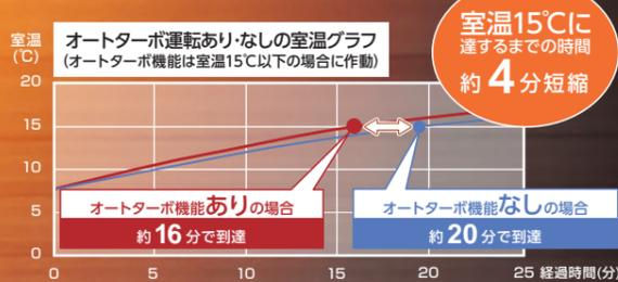
【試験条件】FM-19Fで設定温度23°C、外気温6°C、室温8°Cの本造戸建住宅47畳を想定した当社環境試験室にて測定。
