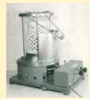
風呂釜に放熱器 を載せた試作品
