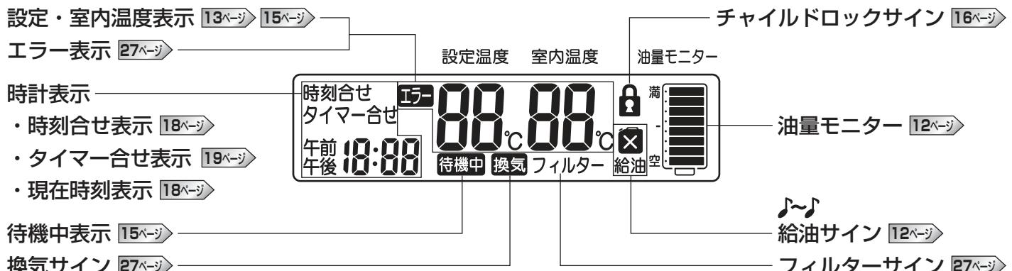
※表示部は、運転停止中でも時刻設定、時刻調節(現在時刻・タイマー運転開始時刻合わせ)、チャイルドロックのボタン操作により、バックライトが約10秒間点灯します。
