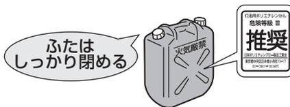
灯油は紫外線だけでなく温度でも変質するため、推奨マーク付の灯油用ポリタンクでも日なたには放置しないでください。変質灯油になります。
