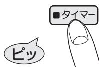
○運転ランプ(赤)が消灯し、タイマーランプ(緑)が点灯すると、セットが完了します。
