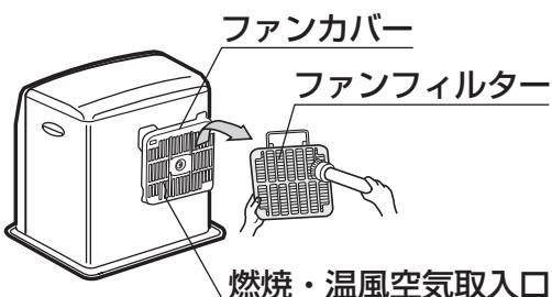
汚れがひどいときは、洗剤などを使って浸泡して、水で洗い流してください。
