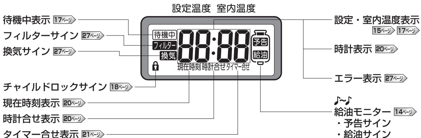
\*表示部は、運転停止中でも表示切換、時刻調節(現在時刻・タイマー運転開始時刻合わせ)、チャイルドロックのボタン操作により、バックライトが約10秒間点灯します。
