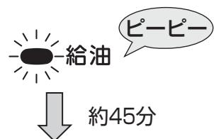
**2** そのまま使用を続けると約45分後に油受皿の灯油がなくなり、「E03」を表示して自動消火します
