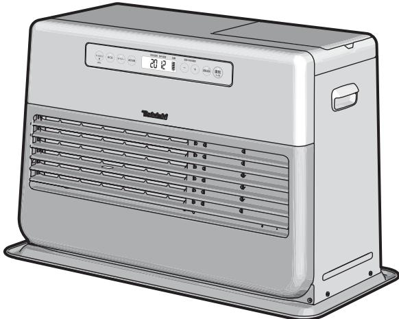
[強制通気形開放式石油ストーブ]
