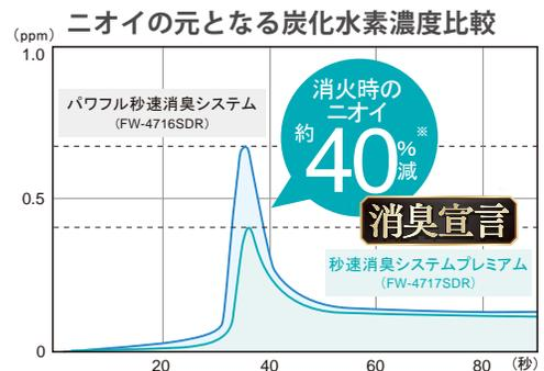
※ 温風吹出口近傍で X 管にて弱燃焼から消火した時の炭化水素濃度を測定。当社 2017 年機種 (FW-4717SDR) と 2016 年機種 (FW-4716SDR) を比較した場合。
